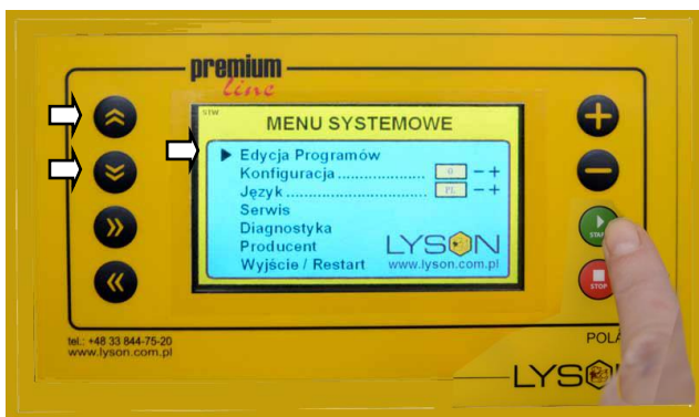
Fot. 7 Przyciskami STRZAŁKA W GÓRĘ / STRZAŁKA W DÓŁ wybieramy odpowiednią pozycję menu (wskazywaną czarną strzałką). Przyciskiem START zatwierdzamy wybór – przechodząc w odpowiednią funkcję Fot. 8
