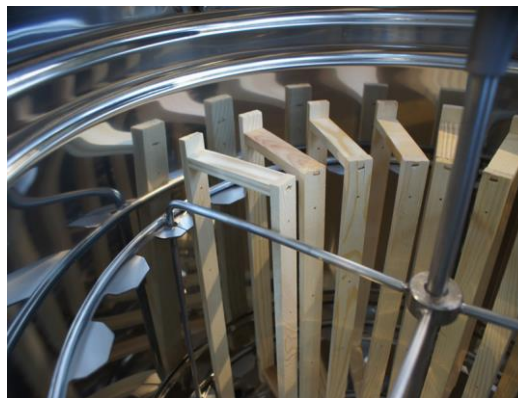
Fot. 2. Prawidłowe ułożenie ramki w koszu radialnym
